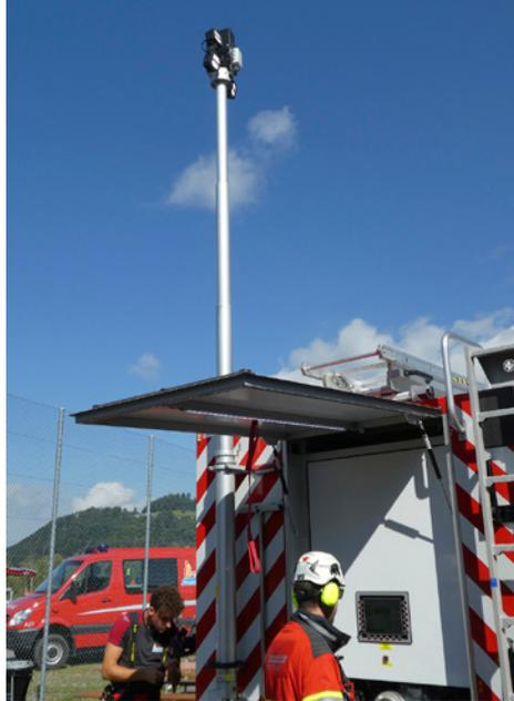
*Beleuchtungsmast und Bedienpanel für die Feuerlöschpumpe am Fahrzeugheck.*
