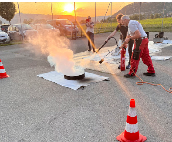
Flüssigbrand: Am Kurs wird brennendes Ethanol mit dem CO 2 -Löscher bekämpft. Das Feuer geht rasch aus, kann aber sofort wieder entzündet werden. Mit Schaum wäre dieses Wiederanzünden nicht möglich.
